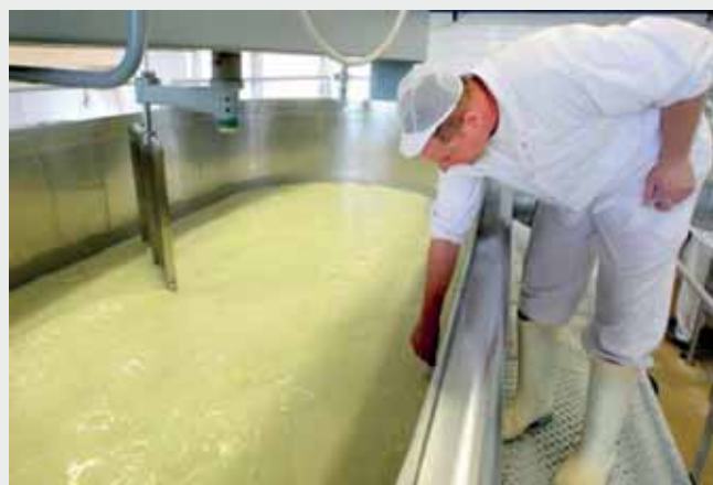
Zpracování sýřeniny probíhá v Mlékárně Vipava na otevřených sýrařských vanách.
